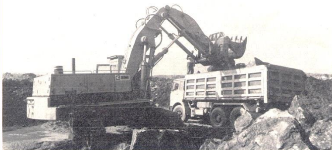
Il 235 F.S. ripreso mentre posiziona esattamente i massi più piccoli.
