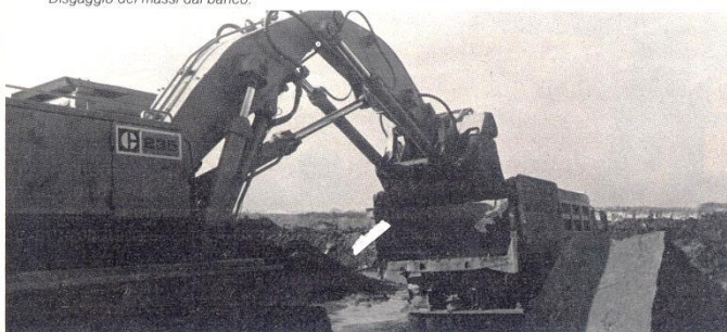
Grazie alle sue dimensioni, la benna del 235 F.S. entra nel cassone e può quindi posizionare comodamente i massi più grossi.
