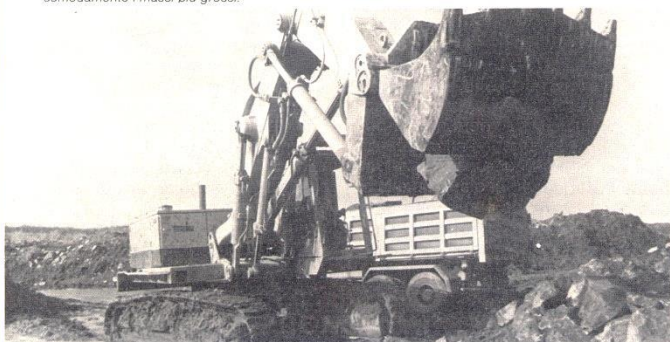
Il 235 seleziona con la benna mordente i massi di pezzatura inferiore.
